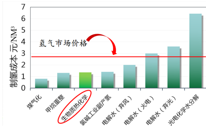
图1. 现阶段各种制氢技术制氢成本分析
