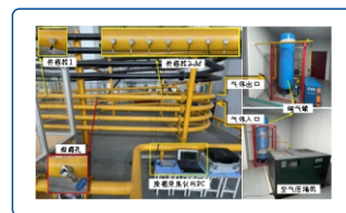
图4 管壁阵列定位实验装置
