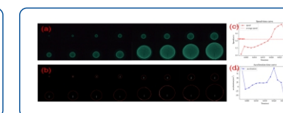
图3 球形火焰传播:(a)输入图像,(b)轮廓检测图像,(c)速度变化曲线,(d)加速度变化曲线
