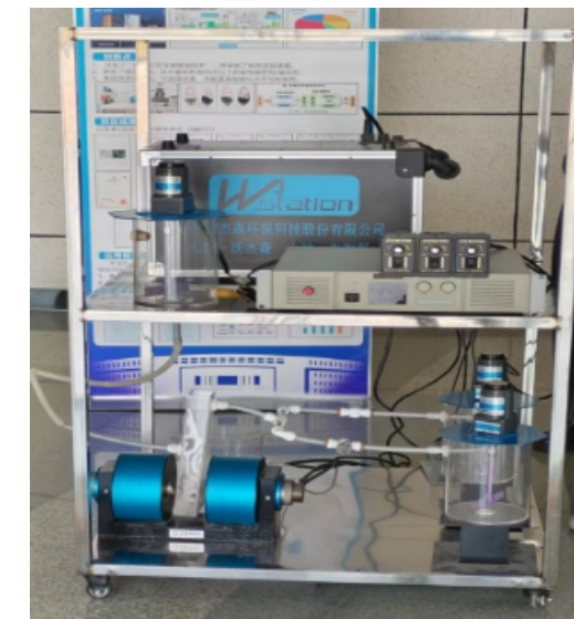
“磁-电耦合”矿井水原位处理试验装置
